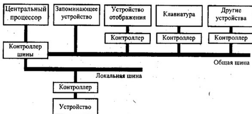
Архитектура компьютера с общей и локальной шиной
